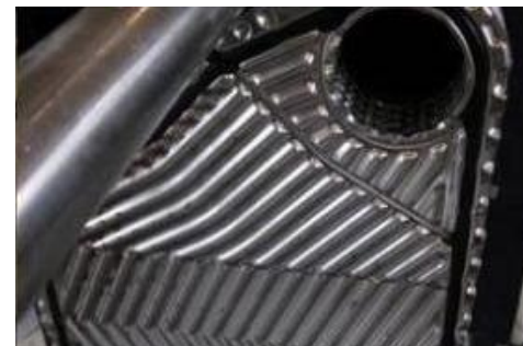
Внешний вид очищаемых пластин теплообменника до и после очистки
